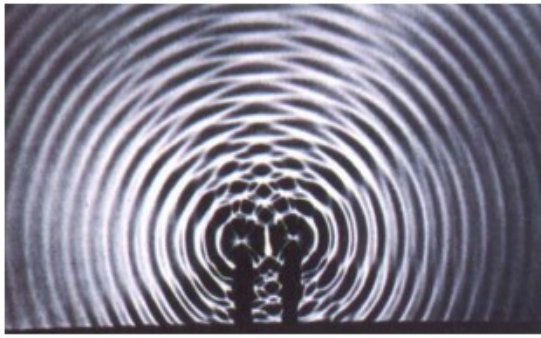
Interferencias producidas en agua por ondas que provienen de focos diferentes.
